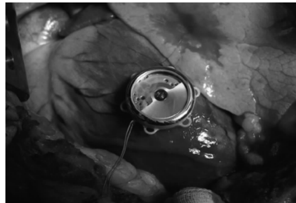
(引自 Ann Biomed Eng, 2013,41(1):131-141 [4] ) 图 1 缝合到羊心脏表面的偏心振动发电机原型
